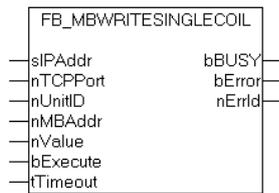
Diese Funktion wird zum Beschreiben eines digitalen Ausgangs(Coil) benutzt. Dabei handelt es sich um einen Bit-Zugriff.
