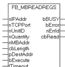
Diese Funktion wird zum Lesen von 1 bis 125 Ausgangs-Register(16 Bit) benutzt. Das erste Byte enthält die unteren Bits und das zweite Byte die oberen acht Bits.
