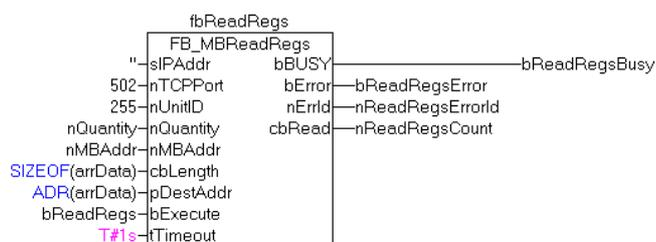
Nach steigender Flanke von "bExecute" und erfolgreicher Ausführung des ReadRegs-Befehls, befinden sich der Inhalt der Register 25 und 26 in dem Array arrData:
