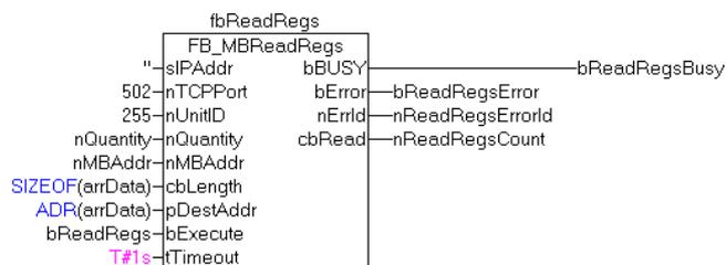
Nach steigender Flanke von "bExecute" und erfolgreicher Ausführung des ReadRegs-Befehls, befinden sich der Inhalt der Register 3-5 in dem Array arrData:
