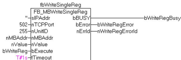
Nach steigender Flanke von "bExecute" und erfolgreicher Ausführung des WriteSingleReg-Befehls, wird in das Register 5 der Wert 16#1234 geschrieben.
