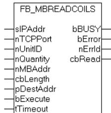
Diese Funktion wird zum Lesen von 1 bis 2000 digitalen Ausgängen (Coils) benutzt. Ein digitaler Ausgang entspricht einem Bit der gelesenen Bytes.
