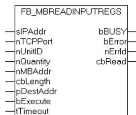
Diese Funktion wird zum Lesen von 1 bis 125 Eingangs-Register(16Bit) benutzt. Endian
