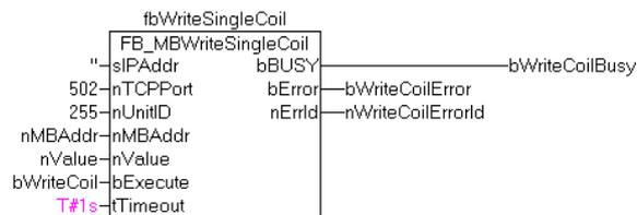
Nach steigender Flanke von "bExecute" und erfolgreicher Ausführung des WriteSingleCoil-Befehls, wird der digitale Ausgang 4 angeschaltet.
