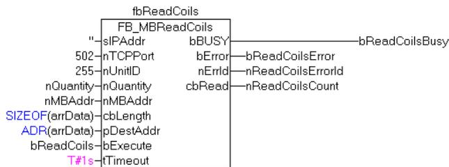
Nach steigender Flanke von "bExecute" und erfolgreicher Ausführung des ReadCoils-Befehls, wird der Inhalt der digitalen Ausgänge 6 - 15 in das Array arrData geschrieben:
