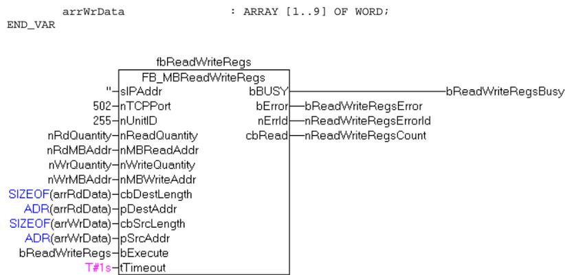
Nach steigender Flanke von "bExecute" und erfolgreicher Ausführung des ReadWriteRegs-Befehls, befinden sich in arrRdData die gelesenen Daten der Register und die Daten aus arrWrData werden in die Register geschrieben.
