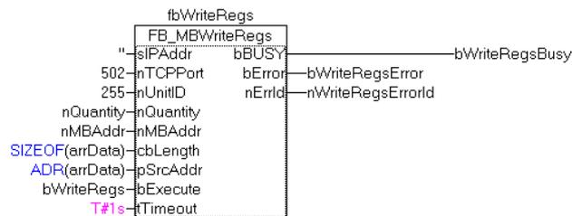
Nach steigender Flanke von "bExecute" und erfolgreicher Ausführung des ReadRegs-Befehls, wird der Inhalt des Arrays arrData in die Register 5-7 geschrieben.
