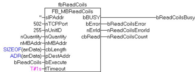
Nach steigender Flanke von "bExecute" und erfolgreicher Ausführung des ReadCoils-Befehls, wird der Inhalt des Arrays arrData in die Ausgänge 15-24 geschrieben:
