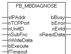
Die Diagnose-Funktion stellt eine Reihe von Tests, für die Überprüfung des Übertragungssystems zwischen dem Master und dem Slave oder für die Überprüfung der verschiedenen internen Fehlerzustände innerhalb des Slaves, zur Verfügung.
