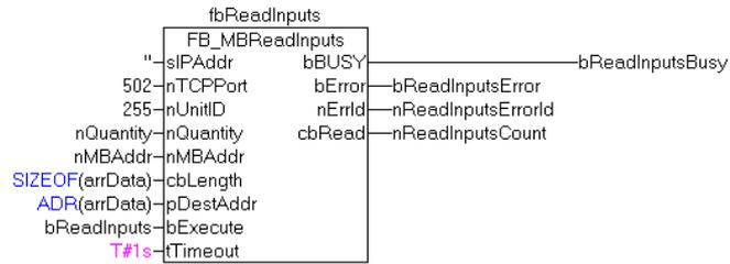
Nach steigender Flanke von "bExecute" und erfolgreicher Ausführung des ReadInputs-Befehls, wird der Inhalt der digitalen Ausgänge 30 - 49 in das Array arrData geschrieben:
