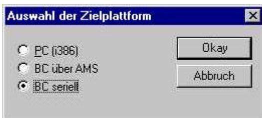
Unter Online/Kommunikationsparameter finden Sie im PLC-Control die Einstellungen zur seriellen Schnittstelle, Portnummer, Baud-Rate usw. Der Busklemmen Controller benötigt folgende Einstellung:
