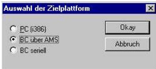
Wählen Sie nach Erstellung Ihres Programms unter der Symbolleiste *Online* das Zielsystem aus. Hierzu muss TwinCAT gestartet sein. Im Beispiel ist dies die Ethernet-Karte mit der Box 1 und die Run-Time 1 des Busklemmen-Controllers.
