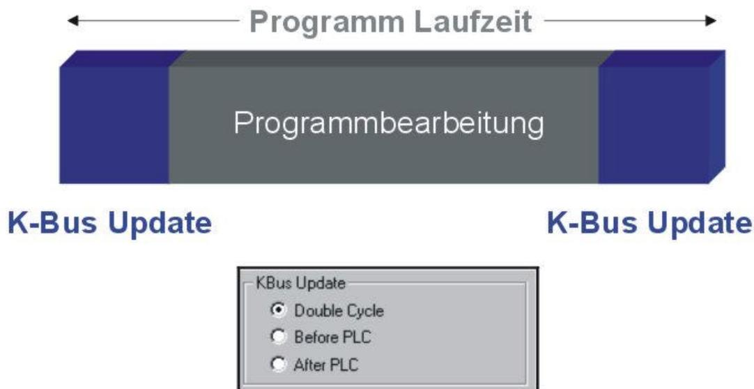
Die Programmlaufzeit besteht aus der Programmbearbeitung und der K-Bus-Zeit. Bevor das Programm aufgerufen wird, fährt der Busklemmen Controller ein K-Bus-Update und liest die aktuellen Eingänge ein. Nach der Programmbearbeitung wird ein zweites K-Bus-Update um die Ausgänge zu schreiben. Die K-Bus-Zeit ist abhängig von Anzahl und Art der gesteckten Busklemmen.
