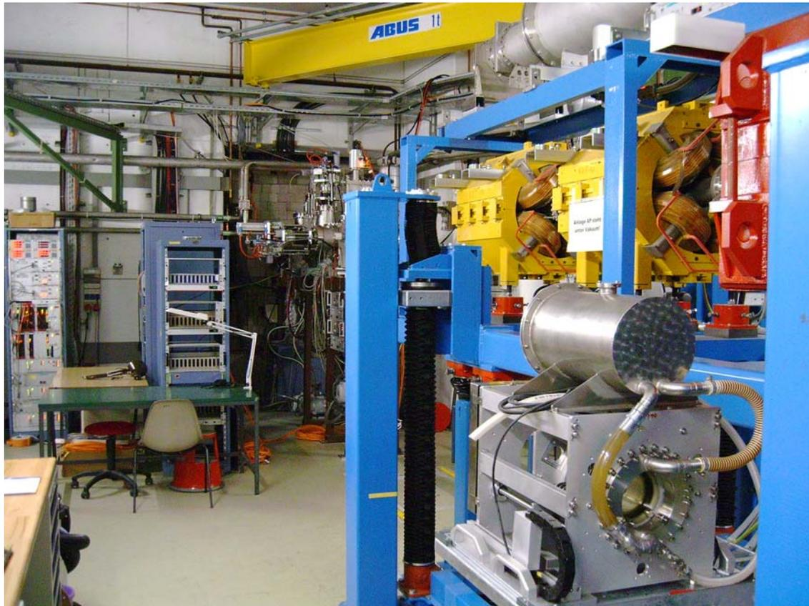
*Abbildung 1: Experimenteller Aufbau im Cave. Die Länge des Aufbaus beträgt ca. 15m, die Höhe ungefähr 2m (rechts). Die Schrittmotorsteuerung befindet sich in einem 19" Rack (hinten links).*
